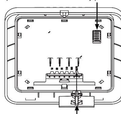
Los ajustes del dispositivo se encuentran en la parte posterior de la unidad para evitar manipulaciones
