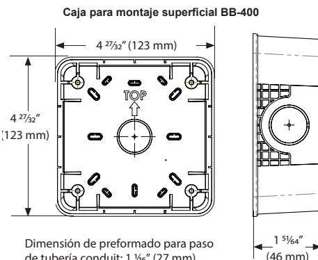
Dimensión de preformado para paso de tubería conduit: 1 1/16" (27 mm)
