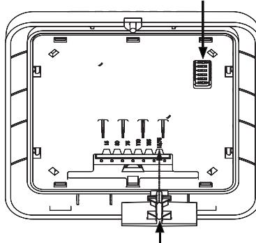
Interrupteur de réglage de candela
