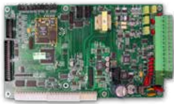
Module réseau de contrôle audio ANC-5000 Le module ANC-5000 fournit un contrôle microphone audio sur le réseau. Le module ANC-5000 s'installe sur une plaque dans le QMB-5000N.
