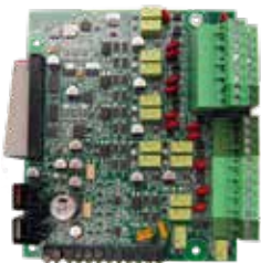
Module réseau de contrôle téléphonique TNC-5000 Le module TNC-5000 fournit cinq circuits téléphoniques câblés pour le panneau d'étage local dont le premier circuit est configurable avec le combiné principal. Le module TNC-5000 s'installe dans le QMB-5000N.
