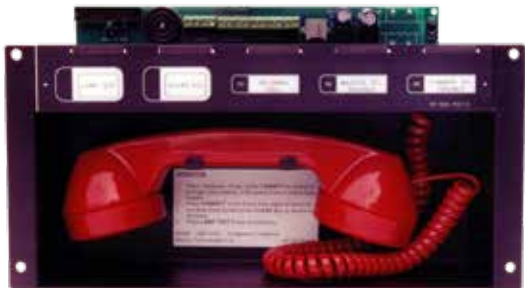
Module de commande réseau principal de téléphone d'urgence QMT-5302N Le module QMT-5302N comprend le combiné principal et des indicateurs de commande communs. Le module QMT-5302N supporte les modules de recherche de personnes et de commutateur de sélection téléphonique QAZT-5302DS. Le QMT-5302N occupe une fente de module dans les boîtiers de la série BB-5000.
