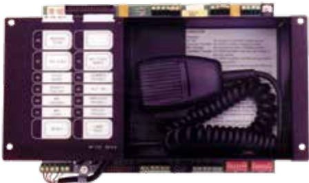
Module de commande réseau principal de recherche de personnes QMP-5101N Le module de commande réseau principal de recherche de personnes QMP-5101N comprend un microphone de recherche de personnes et des indicateurs de commande communs. Le module QMP-5101N permet une recherche générale ou sélective de personnes avec les modules de recherche de personnes zonée et de commutateur de sélection téléphonique QAZT-5302DS. Le QMP-5101N occupe une fente de module dans les boîtiers de la série BB-5000.
