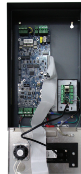
Vue intérieure avec la module de contrôleur de porte simple
