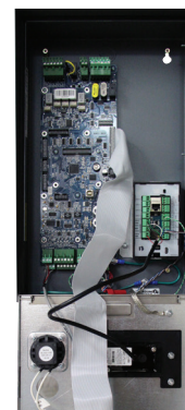
Vue intérieure avec le module de contrôleur de porte simple
