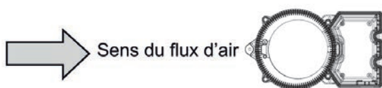
FIGURE 1: Installez le détecteur dans le sens du flux d'air
