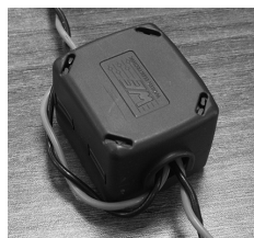
Ferrite installée sur le câble d'alimentation
